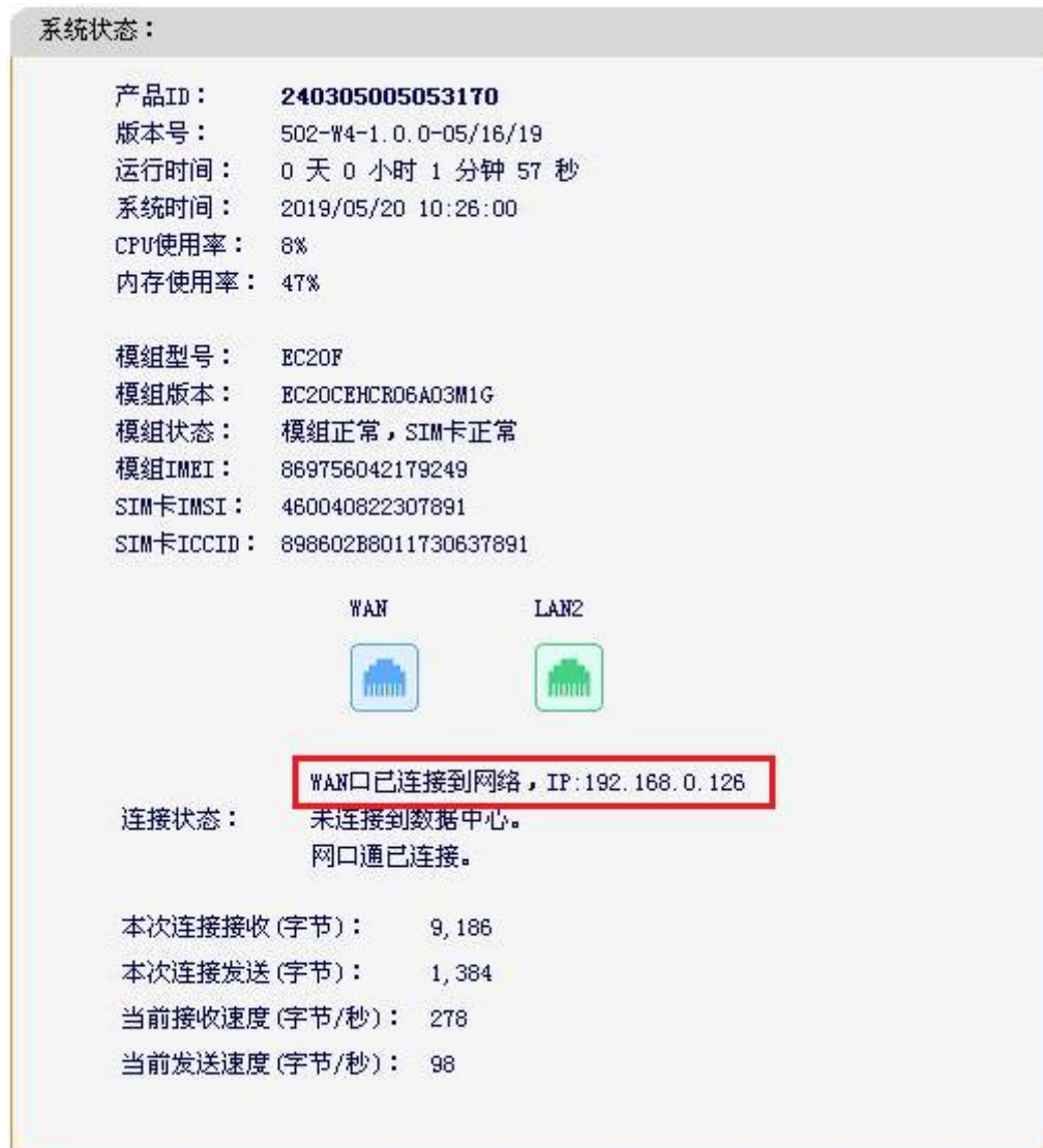
图附 4-6：PLC-502 通过有线接入网络
