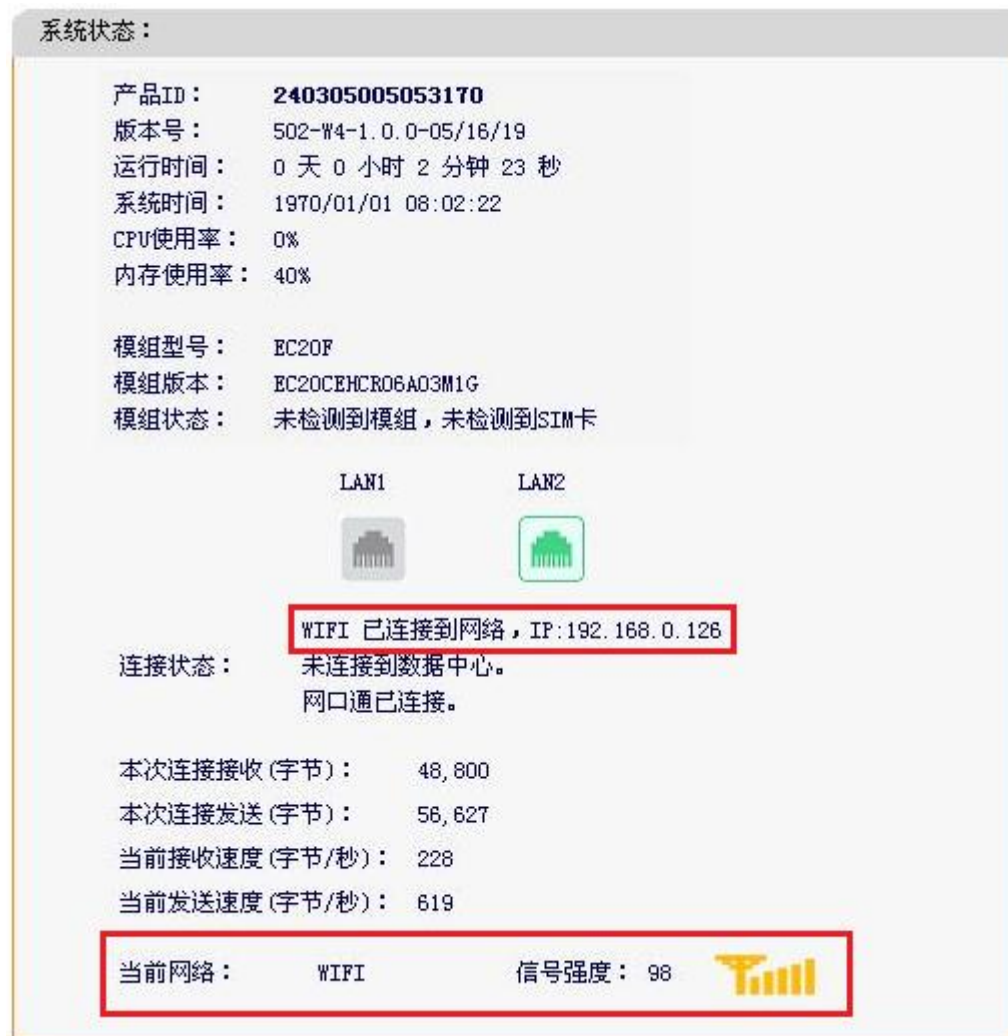
图附 4-12: PLC-502 通过 WIFI 接入网络
